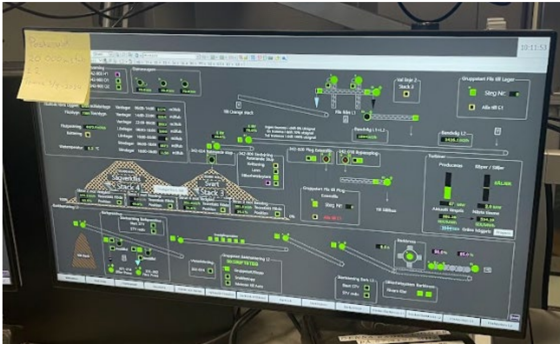
Figur 52. HMI från ABB 800xA
