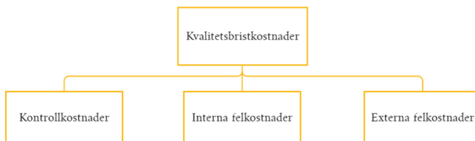
Figur 4: Figuren visar en uppdelning av kvalitetsbristkostnader innehållande kontrollkostnader, interna felkostnader och externa felkostnader (Sörqvist, 2001).
